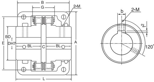
材質/機械構造用炭素鋼
